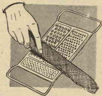
**S**e i denti della vostra grattugia sono ottusi e l'utensile non compie più il suo lavoro con la dovuta efficacia, provate a passare attraverso i denti stessi, ripetutamente, ma senza esercitare una pressione eccessiva, una lima piana mezza-fina.
