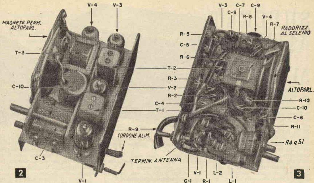
mers sul lato del condensatore di filtro del condensatore di sintonia. Due fili del positivo dovrebbero uscire dal lato inferiore del condensatore elettrolitico. Le due piccole bobine sono montate per mezzo dei loro fili e sistemate in modo da poterle tarare con un cacciavite di plastica.
