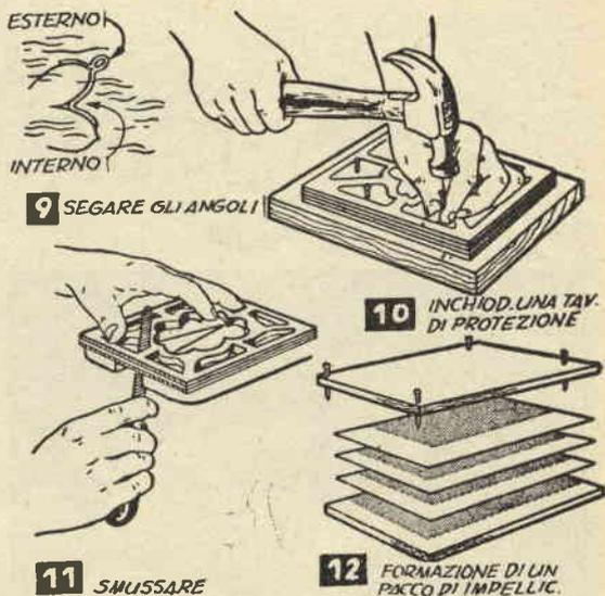
pellucature delicate è il fissare con qualche chiodino sopra al pezzo una sottile tavoletta di scarto (fig. 10), avendo cura di infiggere i chiodi in quelle parti che dovranno esser gettate via. Ribattete in dentro le punte di questi chiodini e i pezzi resteranno a contatto perfetto, per separarsi poi, una volta che il lavoro sia finito, spontaneamente.
