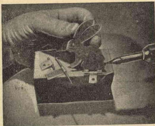
I bersagli sono incernierati alla cinghia. Le cerniere possono essere autoconstruite con un chiodino al quale si avvolgono due linguette lasciate alla base di ogni bersaglio ed una striscetta di lamierino (v. tavola). Le due linguette sono saldate al chiodo che fa perno.
